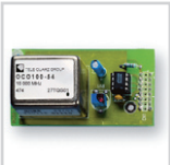
Option H085, ein hochstabiler Oszillator mit einer Stabilität von \pm 5 \times 10^{-9} pro Tag
