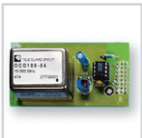
Option H085, oscil- lateur à haute stabilité
