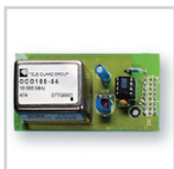
Option H085, oscil- lateur à haute stabilité
